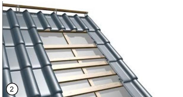
Zur Dachkonstruktion müssen zwei Montageplatten (Höhe ca. 2,5 cm – an der Befestigungsstelle des Trägers und eine Standardplatte an der unteren Stützstelle des Trägers) angeschraubt werden.
