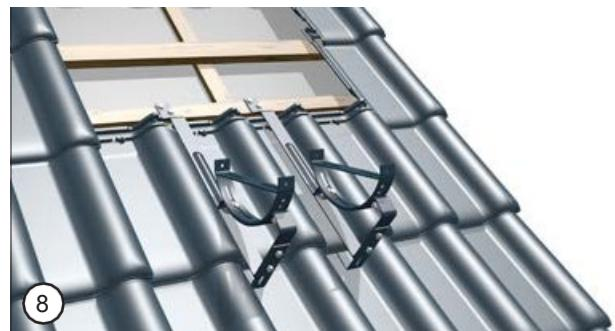
Die Befestigung der Schornsteinbank muss auf der Halterung angebracht und ausgerichtet werden. Beide Elemente müssen mit den im Lieferumfang enthaltenen Schrauben miteinander verschraubt werden (2 Stück/Halterung).
