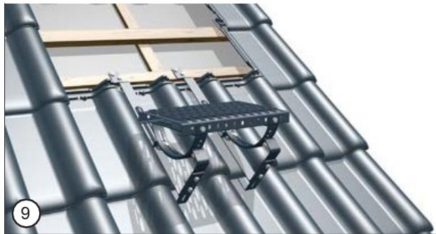
Nach der Befestigung der zweiten Halterung mit der Montagehalterung (mit den mitgelieferten Schrauben) muss die Dachplattform verschraubt werden. Anschließend muss die korrekte Montage überprüft werden, insbesondere die Stabilität aller mechanischen Verbindungen.
