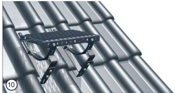
Nach dem Verlegen der oberen Dachziegelreihe müssen die Stellen, an denen die Schlösser ausgeschnitten wurden, abgedichtet werden, z. B. mit einem Dachdichtungsmittel.
