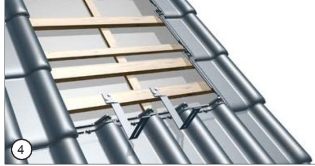
Der nächste Schritt besteht darin, das untere Element der zweiteiligen Halterung (Typ DB/DC) mit Sechskantschrauben an der zuvor montierten unteren Montage-Latte zu befestigen.
