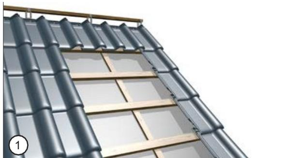
Beginnen Sie die Arbeiten mit der Demontage der Dachziegel an der Stelle, an der die Dachkonstruktion angebracht werden soll.
