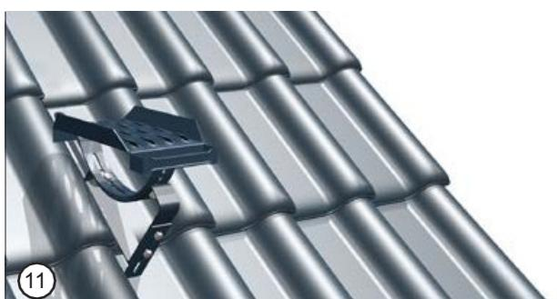
Die Montage der mdm<sup>®</sup>-Schornsteinstufe erfolgt auf die gleiche Weise. Die Schornsteinstufen werden direkt an die Halterung geschraubt (ohne die Befestigung der Schornsteinbank).
